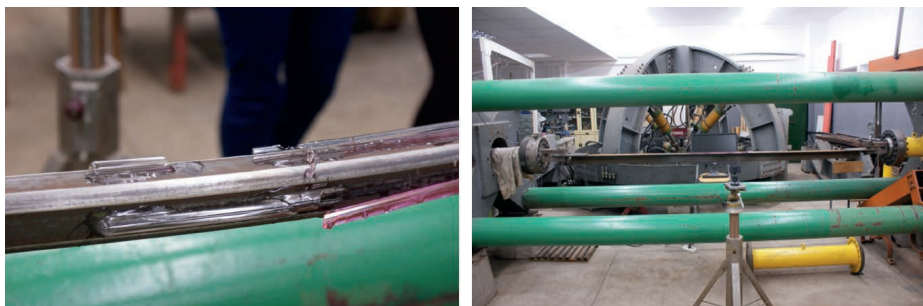
Rys. 1. Badany pręt: rura kwadratowa z elementami systemu i stanowisko badawcze
